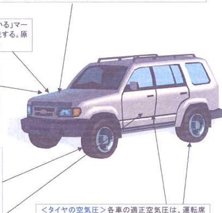
＜タイヤの空気圧＞各車の適正空気圧は、運転席のドアやドアのフレーム部分に表示されている。空気圧が適正でないと、タイヤの寿命や運転に影響があるのでばかりでなく、ガソリンも余分に消費されるので、時々チェックすること(タイヤが冷えている時にチェック)。チェックするためにエアゲージ(\$10以下。デジタル式はもう少し高め)を用意する。タイヤのエアキャップを外し、エアゲージをバルブに押し付けて空気圧を測定する。適正值よりも少ない場合は、ガソリンスタンドなどにあるエアポンプで空気を足す。
